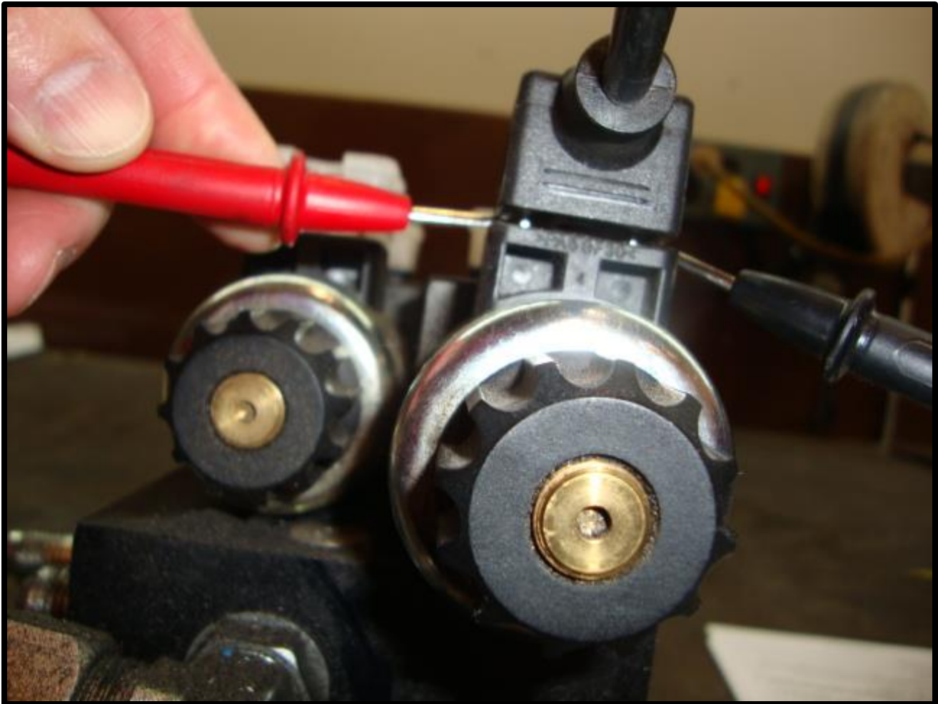
Fig. 8.4 Checking Din Plug Voltage
